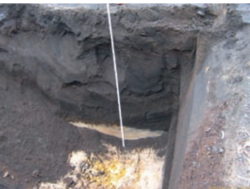
Schlackenanfüllungen auf dem Werksgelände
