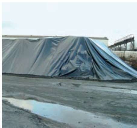
durch Folienabdeckung gesicherte Lagerhalden
